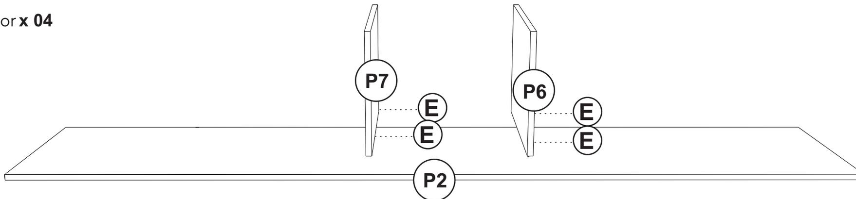
2. Encaixe as peças P11, P7, n°P6, P13 e P5 na peça P2.
