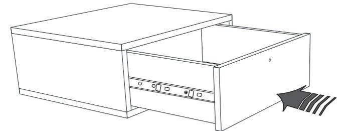
Figura 4. Demonstração do encaixe da gaveta.
