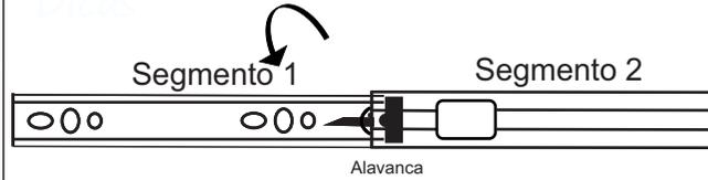
Antes de parafusar o segmento 2/3, é preciso alinhar o primeiro furo de ambos para em seguida colocar o parafuso e fixar os dois na lateral do gabinete. (Conforme figura 1)
