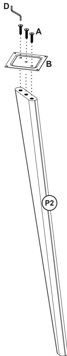
**2.** Fixar o conjunto dos pés com suporte no tampo P1 com os parafusos C. Em seguida cole os feltros E na pota inferior dos pés.
