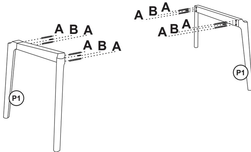
**2.** Fixar as travessas nas bases, utilizando a meia lua C e a porca D, conforme o detalhe, nas barras rosqueadas A, posicionadas no passo anterior. Utilize a chave G para dar o aperto nas porcas.
