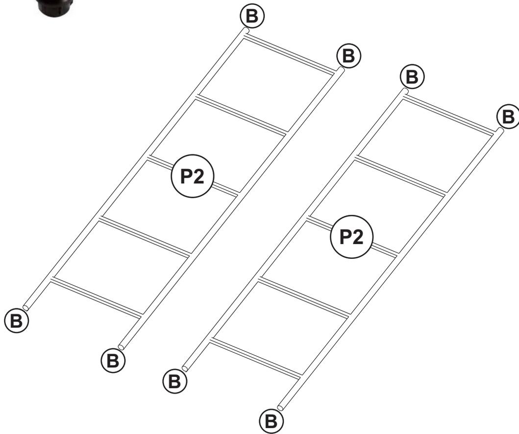
**2.** Encaixe a peça P1 nas peças P2 e parafuse com a letra A.
